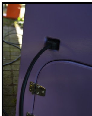
In geval van storing, controleer of het snoer niet los zit
